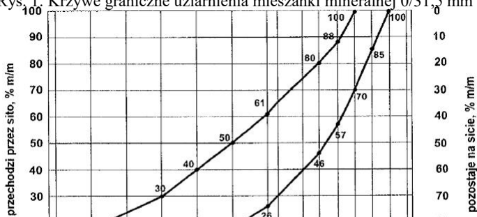
Rys. 1. Krzywe graniczne uziarnienia mieszanki mineralnej 0/31,5 mm
